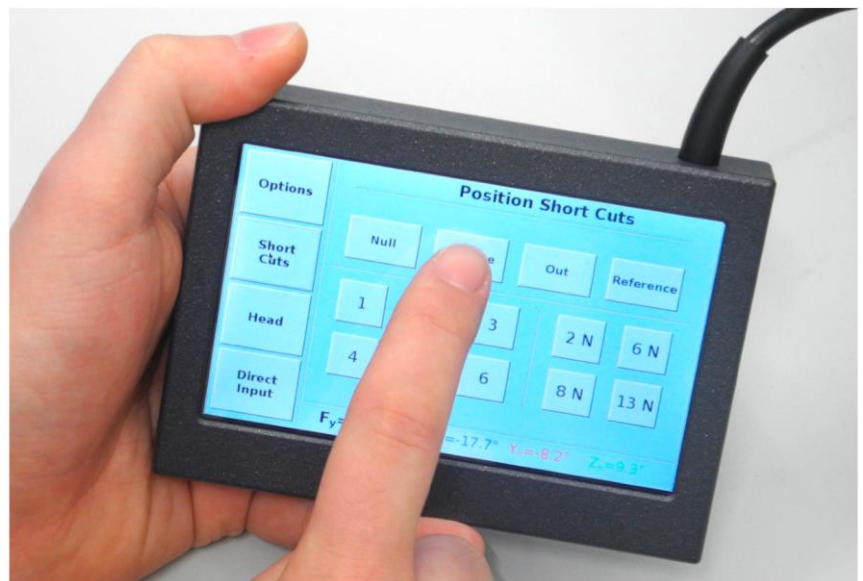
HHP IV のタッチパネル：設定操作画面
