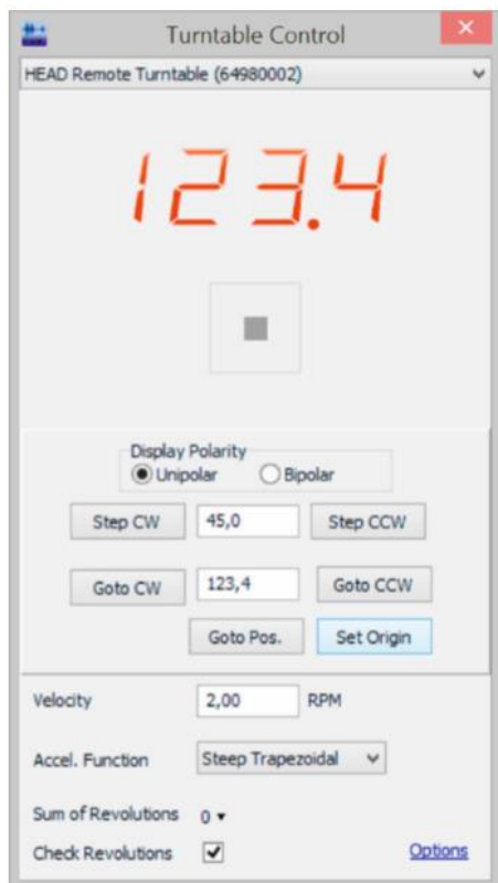
分析システムACQUAのターンテーブル制御画面
